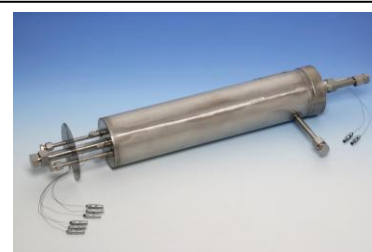
ATR der 8. Generation aus der Jülicher Fertigung. Der ATR 8 ist der Ausgangspunkt für die industrielle Fertigungstechnik in ADELHEID
